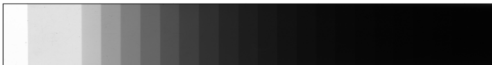
Рис. 2. Калибровочная линейка пошагового градиентного перехода от абсолютно белого цвета к абсолютно черному
